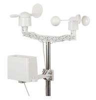
Figure 1: SparkFun Weather Meter
